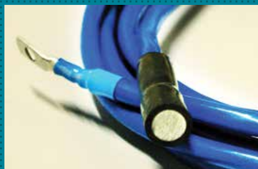
Вспомогательный электрод площадью 1 см 2
