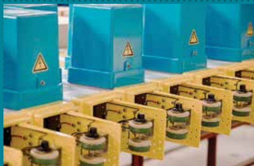
Контрольно-измерительные пункты с реостатными БСЗ
