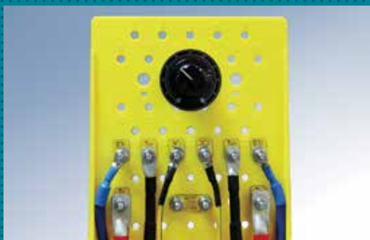
Клеммная панель с одноканальным БСЗ-10А
