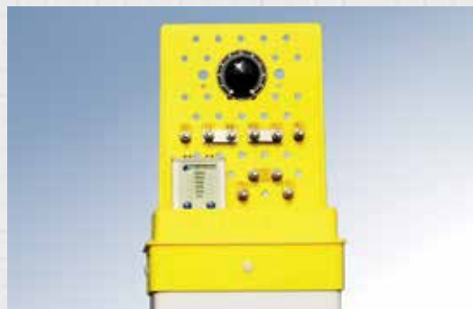
Контроллер МКИ, установленный в КИП
