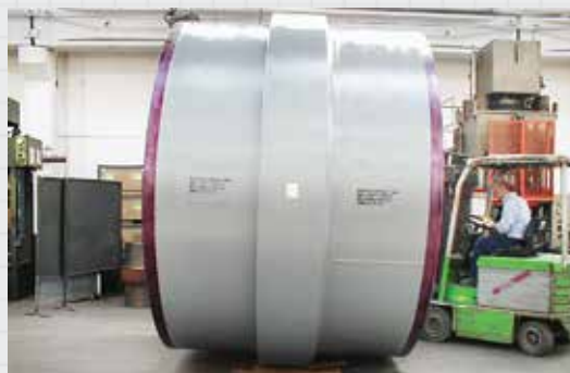
Изолирующая монолитная муфта диаметром 3251 мм для водовода
